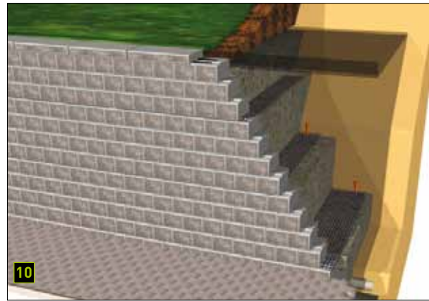
Ripiegatura del geotessile e completamento del muro
