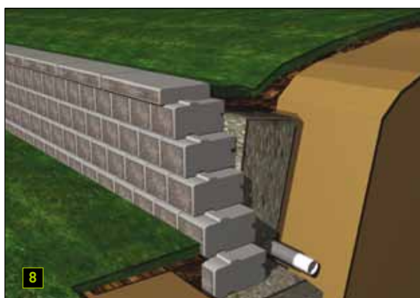
Posizionamento del materiale drenante di riempimento
